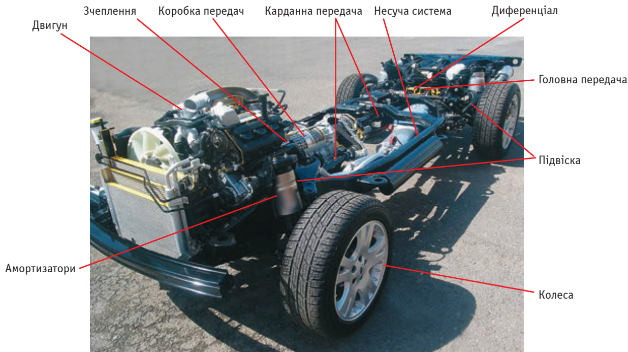
Рис. 1. Шасі та двигун повноприводного автомобіля Land Rover
