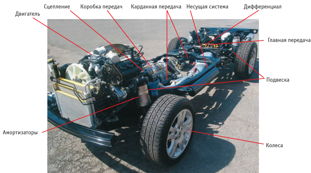
Рис. 1. Шасси и двигатель полноприводного автомобиля Land Rover
